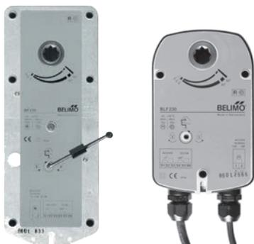
Электромеханический привод с возвратной пружиной представляет собой целостный механизм, который может устанавливаться непосредственно на ось заслонки. Данный тип приводов предназначен для управления заслонкой огнезадерживающих клапанов в условиях повышенных температур окружающей среды.
